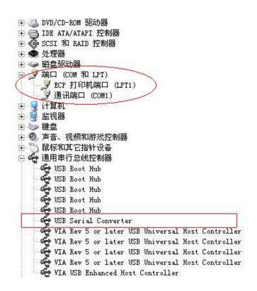
附 1:在打開的"設備管理器"中,用滑鼠右鍵點擊"USB Serial Converter", 在彈出的功能表中選擇"屬性"
