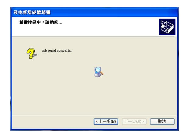
7、系統提示找到兩個驅動程式,第一個為 "RS232 轉接頭"驅動,第二個為 "RS232 線"驅動,根據自已的產品選中其中之一,點擊 "下一步"
