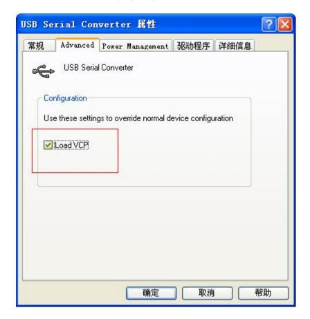
附 3:從電腦 USB 埠拔出 USB 2.0 TO RS232 設備,再重新插入原 USB 埠後即可
